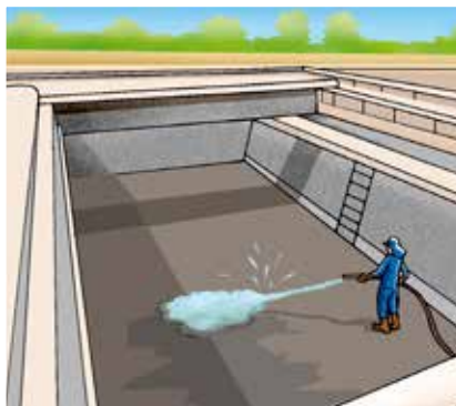
FIGURA 34: OPERADOR LIMPIANDO EL TANQUE DE UNA PTAR SIN BARBIJO, CORRIENDO EL RIESGO DE TENER UNA INFECCIÓN POR LAS SALPICADURAS
