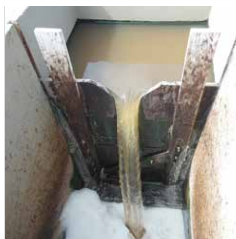
FIGURA 33: USO DE UN VERTEDERO DE AFORO HECHO A MANO CON UNA ESCOTADURA TRIÁNGULO DE 90 GRADOS CON BORDES DE GOMA PARA QUE SE ADAPTEN A LA CÁMARA .
